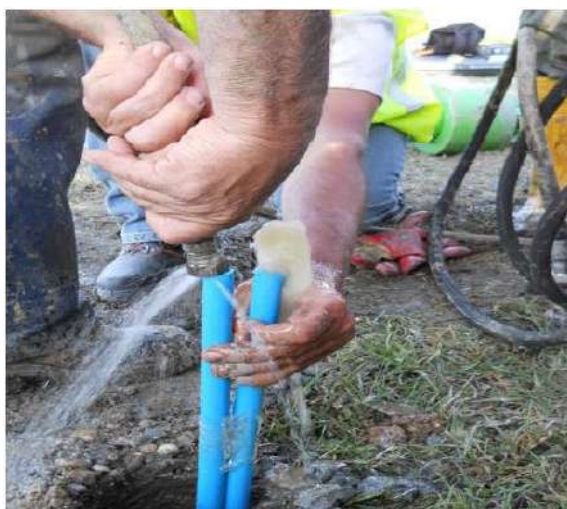
Figura 4.11 – Testimi i funksionimit të tubave vertikale piezometrike në shpimin Ph.1 S7 BH 8230 1
