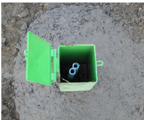
Figura 4.12 – Tubat vertikale në shpimin Ph.1 S7 BH 8230 1 pasi që shpimi ka përfunduar.
